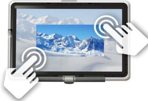
그림 2 : Multi-Touch Gestures 터치스크린상에서의 크기 조절 그림
