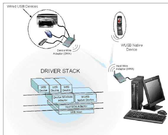
Figura 5. Stack hardware e software per un sistema Wireless USB con connesso un dispositivo USB cablato
