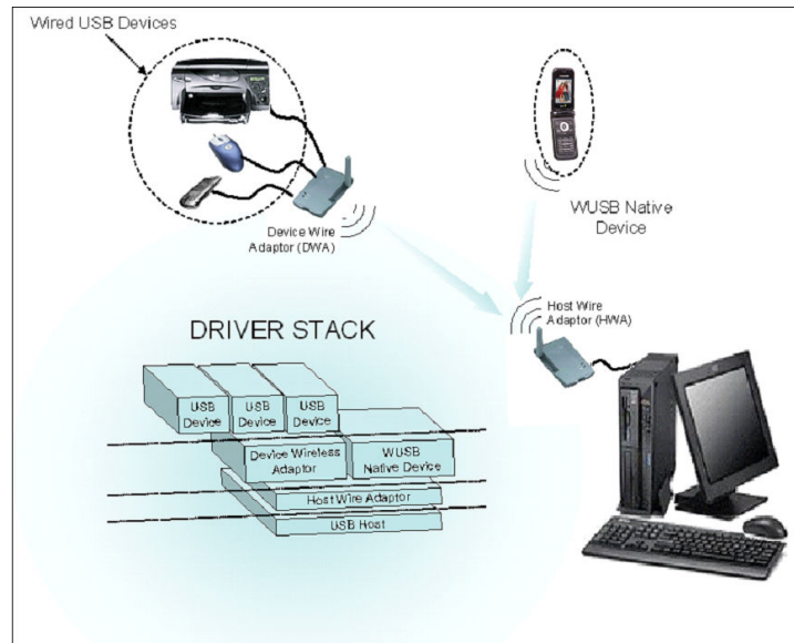
圖 5. 無線USB系統搭配有線USB裝置連線的硬體與軟體堆疊
