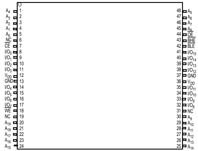
图 8. 48-pin TSOP I (12 × 18.4 × 1 mm), 无 ERR 的单芯片使能, CY7C1061G [6] 封装 / 等级 ID: ZXI
