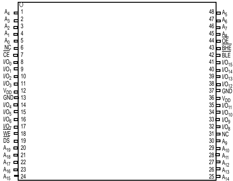
图 4. 48 pin TSOP I (12 × 18.4 × 1 mm) 引脚分布 (顶视图) [6]
