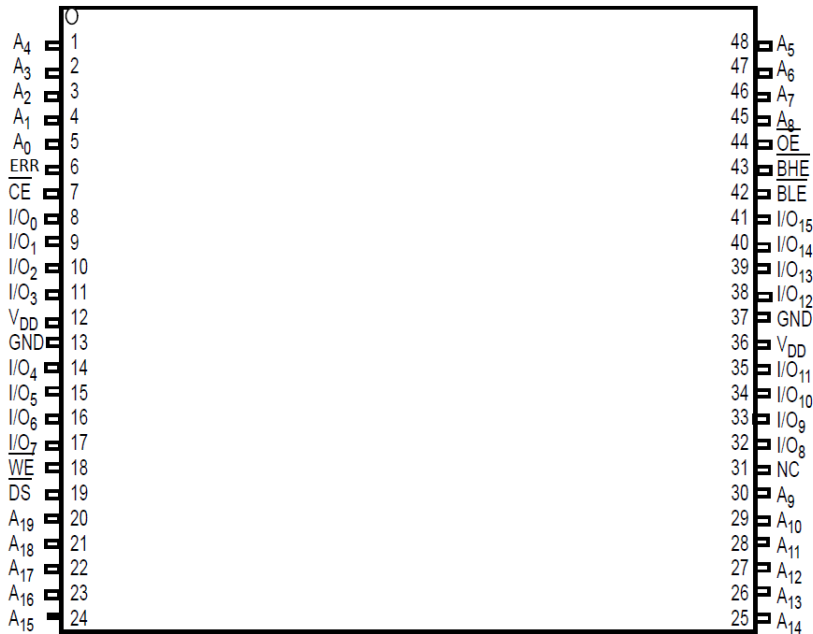
図 5. 48 ピン TSOP I (12x18.4x1mm) ピン配置、ERR 出力はピン 6 に位置 (上面図)
