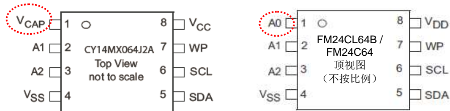
图 2. 1 Mb nvSRAM 与 F-RAM 的封装比较
