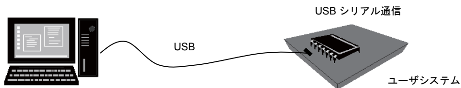
図 1-4 USB DIRECT Programmer の基本構成
